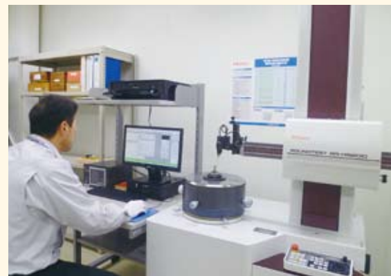
ミツトヨの特殊・高精度真円度・円筒形状測定機 ラウンドテスト RA-H5200AH (非接触センサー付属)
