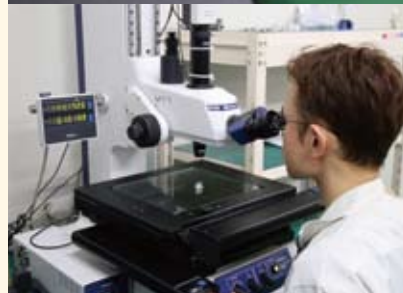
ミットヨのCNC三次元測定機・CRYSTA-Apex S776と測定顕微鏡
